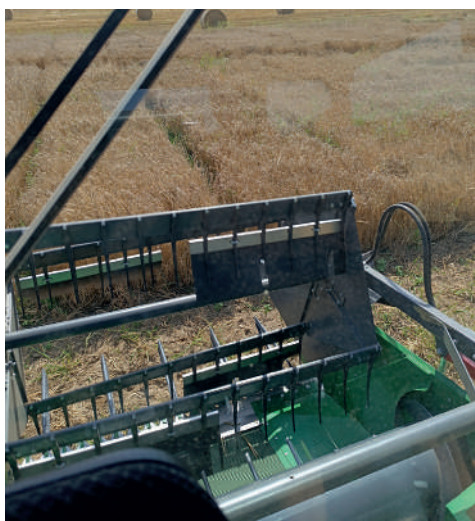
Fot. 4. Zbiór poletek doświadczalnych systemu PDO w PODR w Lubaniu (14.08.2025) kombajnem poletkowym Zürn 150 (widok maszyny podczas pracy, automatyczny system poboru prób ziarna, widok operatora)
