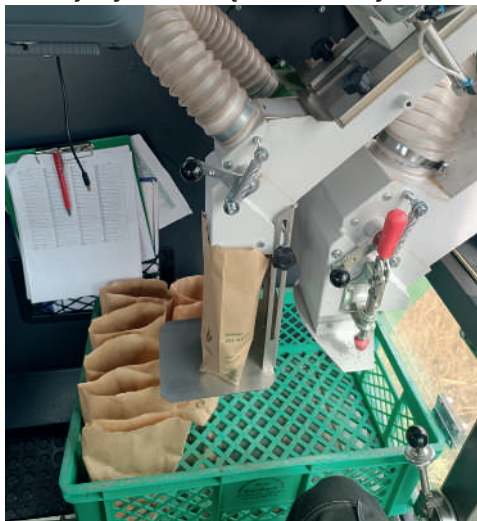
Fot. 4. Zbiór poletek doświadczalnych systemu PDO w PODR w Lubaniu (14.08.2025) kombajnem poletkowym Zürn 150 (widok maszyny podczas pracy, automatyczny system poboru prób ziarna, widok operatora)
