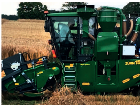
Fot. 4. Zbiór poletek doświadczalnych systemu PDO w PODR w Lubaniu (14.08.2025) kombajnem poletkowym Zürn 150 (widok maszyny podczas pracy, automatyczny system poboru prób ziarna, widok operatora)
