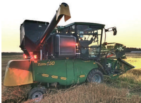
Fot. 4. Zbiór poletek doświadczalnych systemu PDO w PODR w Lubaniu (14.08.2025) kombajnem poletkowym Zürn 150 (widok maszyny podczas pracy, automatyczny system poboru prób ziarna, widok operatora)
