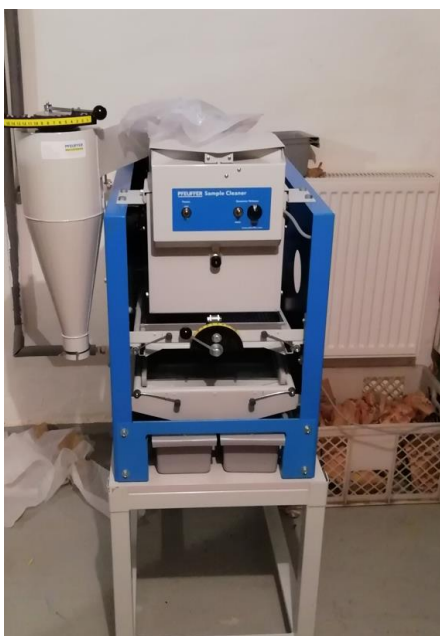
Fot. 2. Wialnia/sortownik laboratoryjny do czyszczenia prób ziarna o masie nie przekraczającej 1 kg
