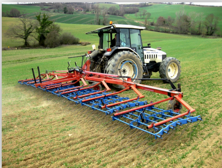
fot. 4 Brons chwastownik - mechaniczne zabiegi pielęgnacyjne w zwartych łanach. źródło: www.agromaksimus.pl
